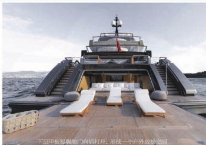
下层甲板艉舱门向后打开，形成一个户外放松空间 开放式楼梯衔接主甲板客厅和下层甲板海滩俱乐部
